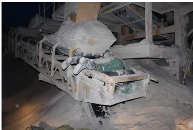
*Ночью, около 05.00 часов, был обнаружен труп Галина М. В., руку которого затянуло под натяжной барабан конвейерной ленты конвейера специального СМД-151-60, а верхнюю часть тела затянуло в правую часть по ходу движения каркаса конвейерной ленты, зажало между каркасом и натяжным барабаном (Рис).*
